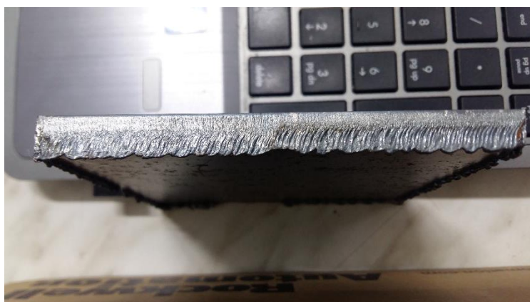
Рис 4. Грат на нижней поверхности детали
