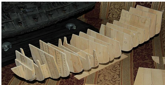
Рис. 2. Готовый каркас корпуса
