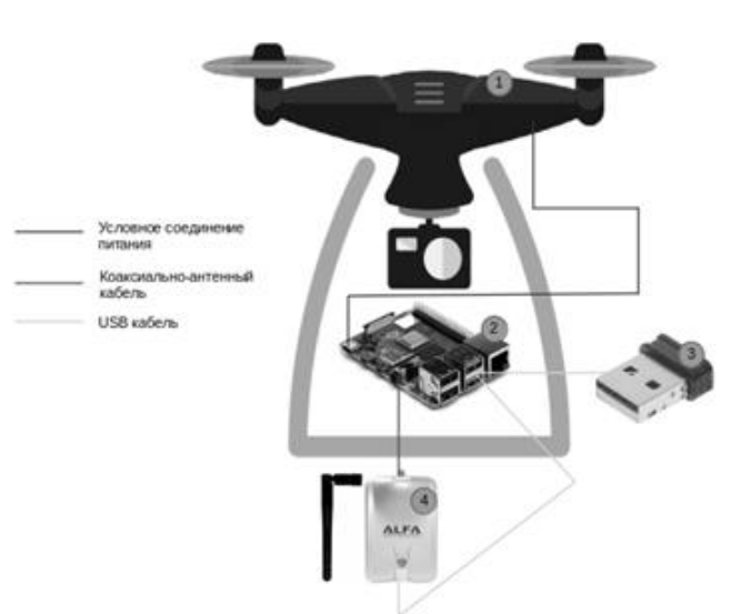
Рис. 1. Схема соединения комплектующих
