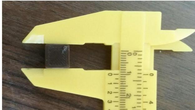
*Рис. 6. Проверка точности распечатанного образца*
