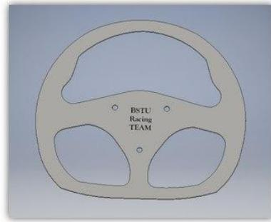
Твердотельная модель основания рулевого колеса
