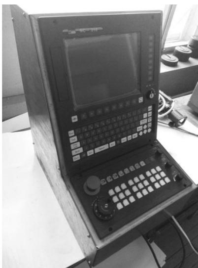
*Рис. 3. Пульт оператора шлифовально-заточного станка*
