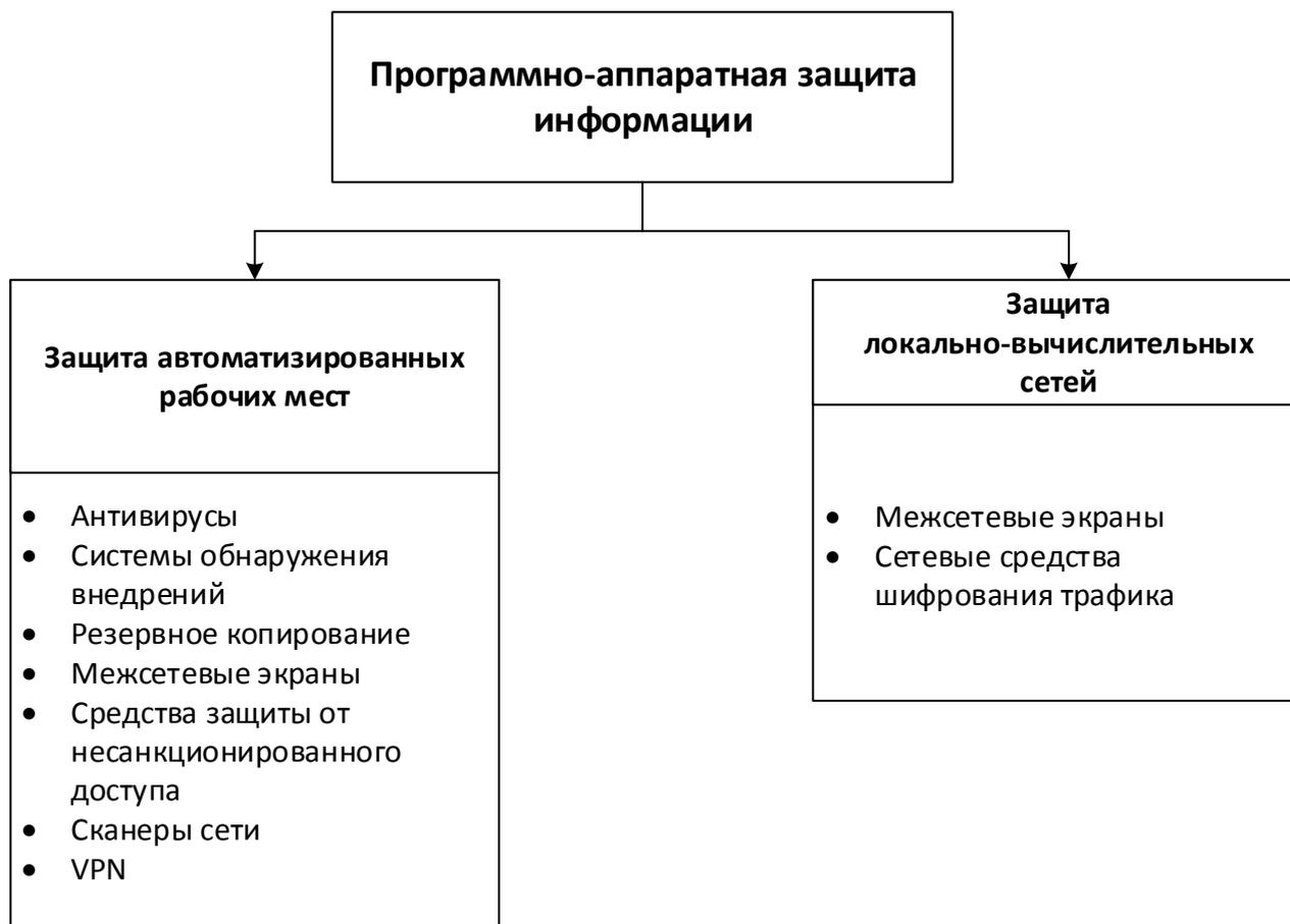
*Рис. 1. Структура программно-аппаратной защиты информации*
