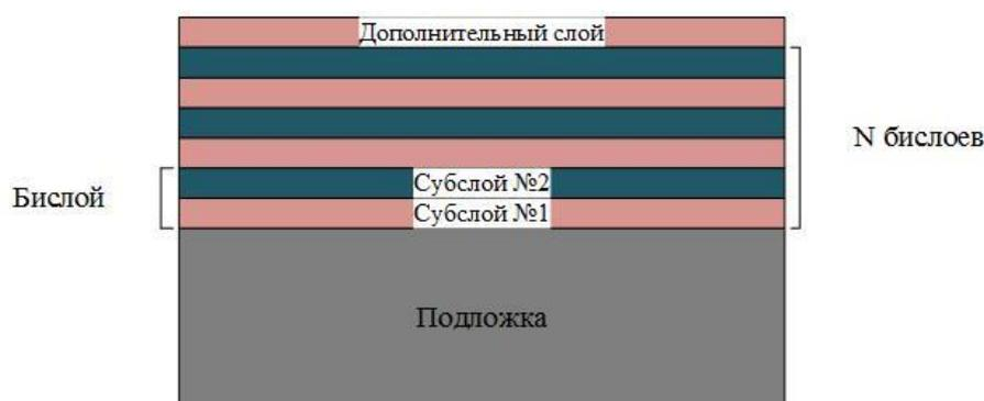
*Рис. 1. Схематичное изображение типичной наноламинатной структуры с дополнительным верхним слоем*
