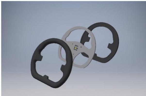
*Рис. 3. Рулевое колесо в разобранном виде*
