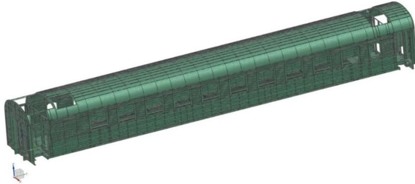
*Рис. 1. Конечно-элементная модель кузова пассажирского вагона*
