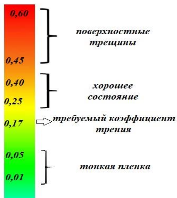
Рисунок – 1.4 Уровни коэффициента трения в контакте колеса с рельсом
