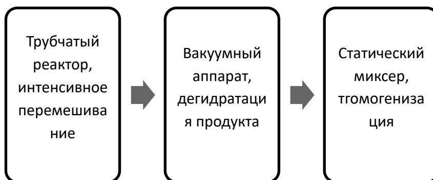
Рисунок 2.4 Схема процесса изготовления смазочного материала
