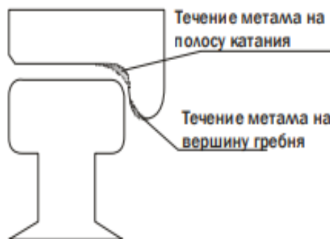
Рисунок – 1.5 Результат пластической деформации в паре трения колесо-рельс [178]
