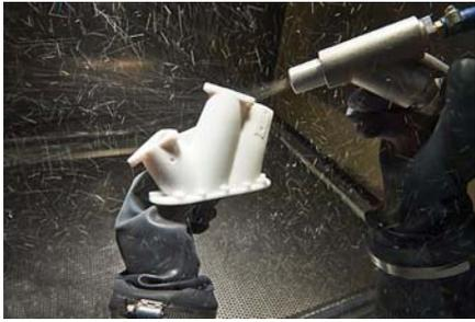
Рис. 2. Метод пескоструйной обработки
