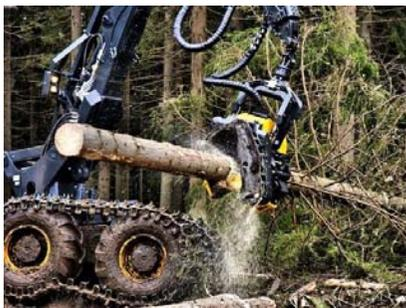
Рис. 2. Работа харвестера
