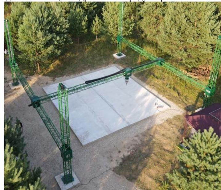
Рис. 1. Строительный 3D принтер «АМТ» S-300
