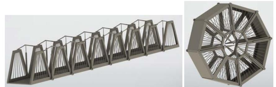
Рис. 3. Трехмерные геометрические модели моста в развернутом и свернутом положениях
