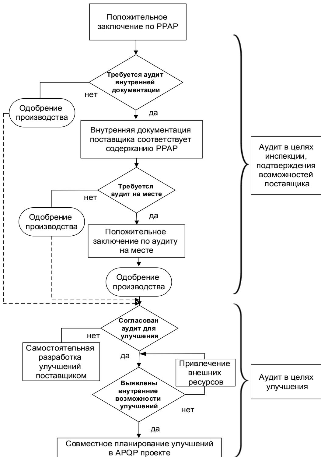
Рисунок 6 – Общая схема алгоритма оценки возможностей поставщика автокомпонентов
