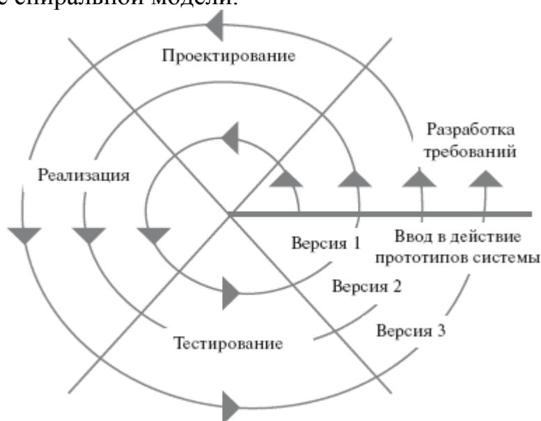
Рис. 1. Спиральная модель жизненного цикла ИС
