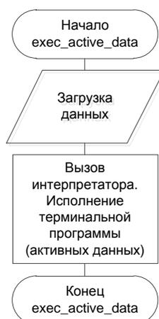
Рис. 3. Алгоритм обработки активных данных
