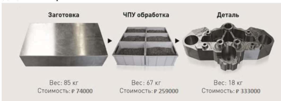
Рис. 2. Изготовление детали по традиционной технологии
