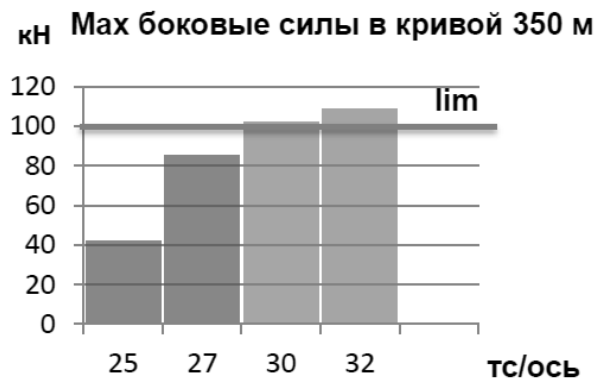
Рис. 1. Боковые силы при движении по радиусу кривой 350м
