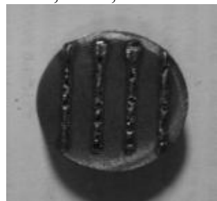
Рис. 1. Образцы из чугуна, обработанные лазером с частичным плавлением поверхности
