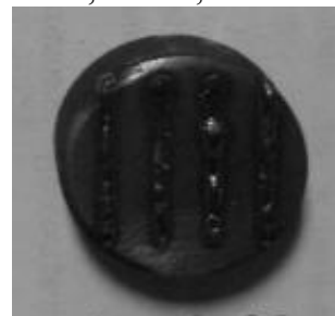
Рис. 1. Образцы из чугуна, обработанные лазером с частичным плавлением поверхности
