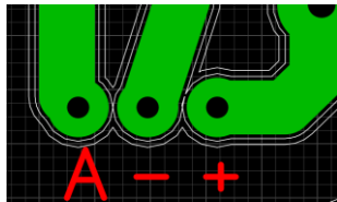
Рис.3. Симуляция изоляционных дорожек в программе Sprintlayout.
