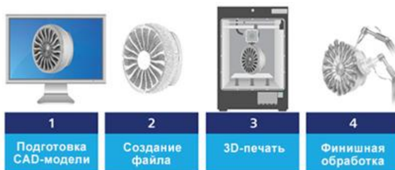
Рис. 1. Обобщенный процесс производства изделия в аддитивных технологиях
