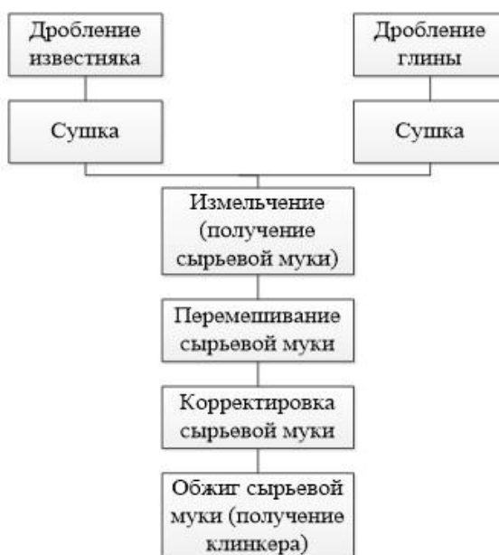
Рис. 2. Схема производства портландцементного клинкера сухим способом
