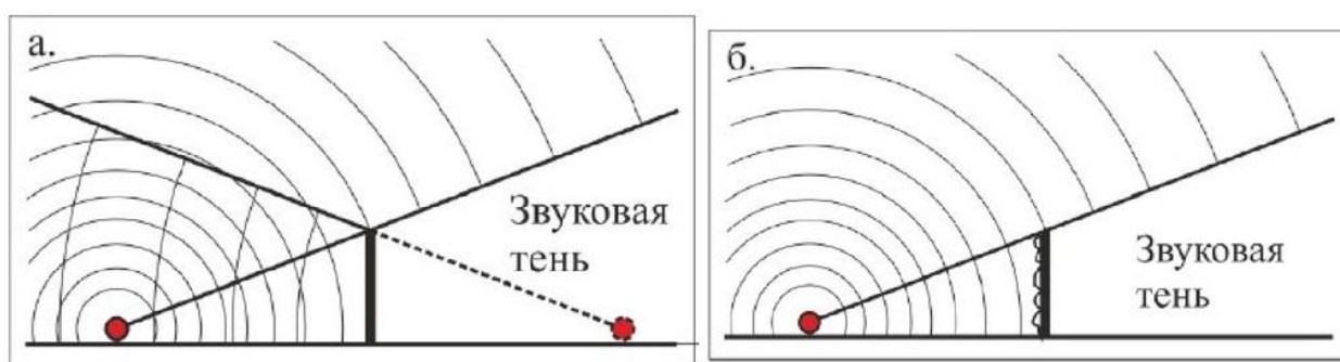
Рис. 2. Схема распространения шума: а) шумоотражающего, б) шумопоглощающего
