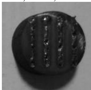
Рис. 1. Образцы из чугуна, обработанные лазером с частичным плавлением поверхности
