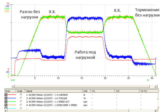
Рис. 6. Режим DTC с коэффициентом усиления пропорционального звена K_p=20
