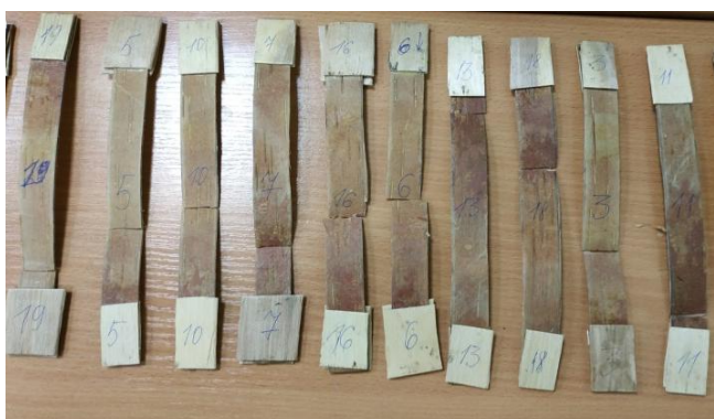
Рис. 2. Образцы бересты после испытания на разрыв вдоль волокон
