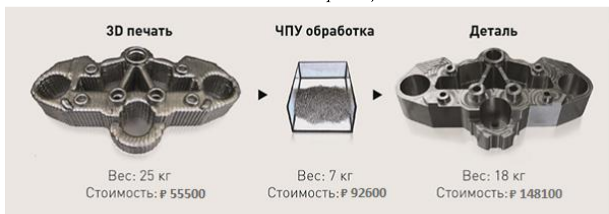
Рис. 3. Изготовление детали по аддитивной технологии 3DMP
