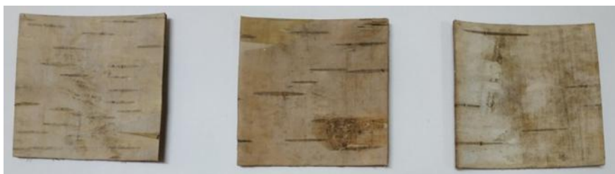
Рис. 1. Образцы бересты для определения плотности и водопоглощения
