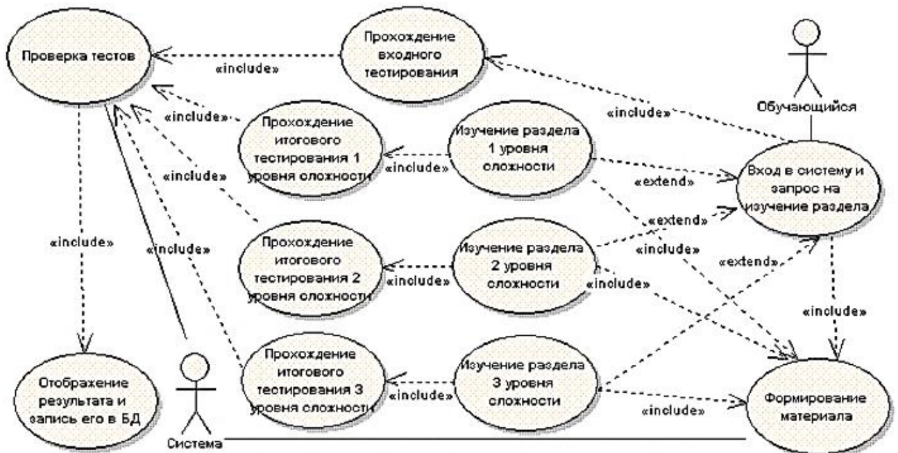
Рисунок 2.11 – Трехуровневая система адаптивного тестирования
