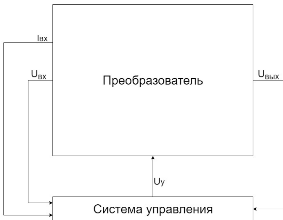
Рис.1.6. Обобщенная система управления импульсным преобразователем с коррекцией коэффициента мощности
