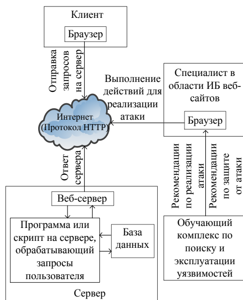
Рис. 2. Схема проведения атак на веб-приложение с использованием обучающего комплекса
