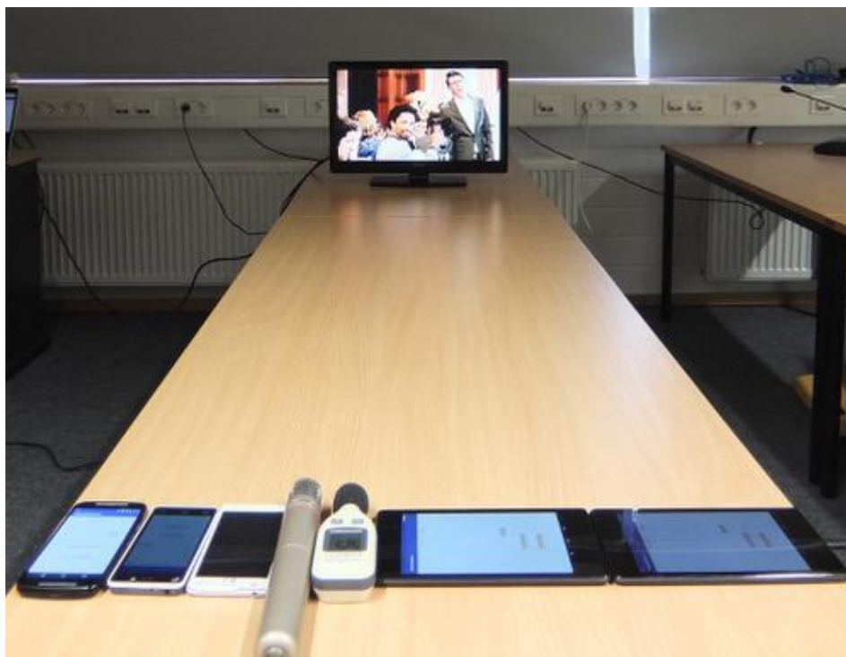
Рис. 2. Тестовая установка в лаборатории Браунивейгского технического университета. Распознавание маячков с расстояния 2 метра на частоте 18 кГц составляет от 70% до 100%, а на частоте 20 кГц — от 75% до 100%, в зависимости от качества телефона
