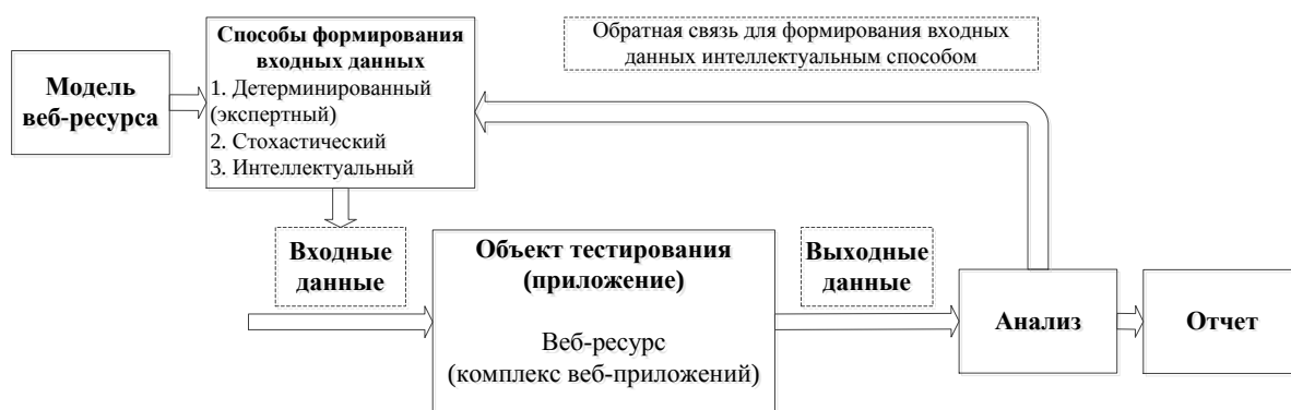
Рис. 1. Схема фаззинга с обратной связью при формировании входных данных
