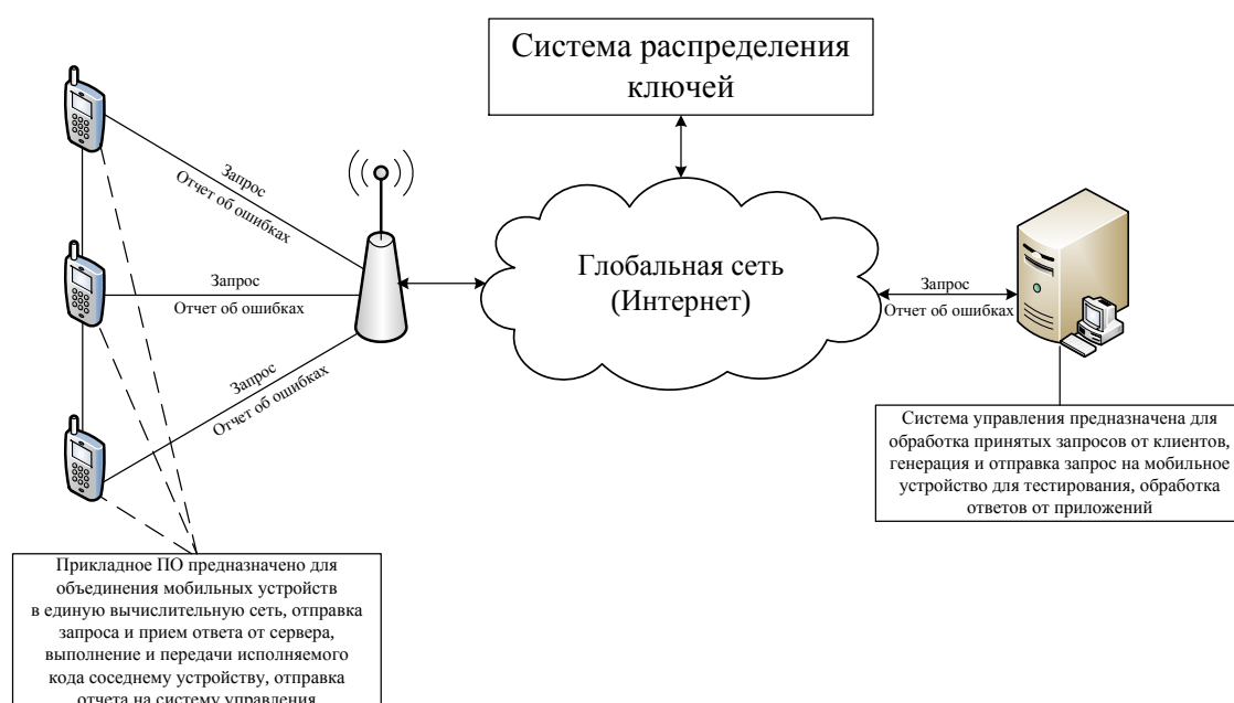
Рис. 2 Функциональная схема инфраструктуры сети мобильных устройств
