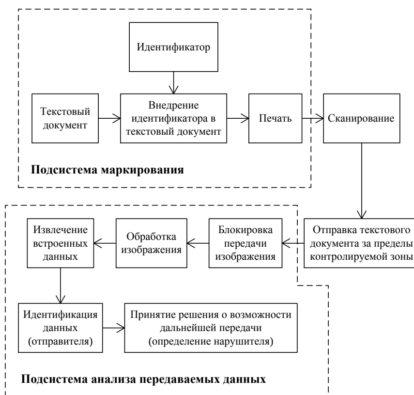
Рис. 1. Функциональная модель подсистемы защиты текстовых данных от утечки
