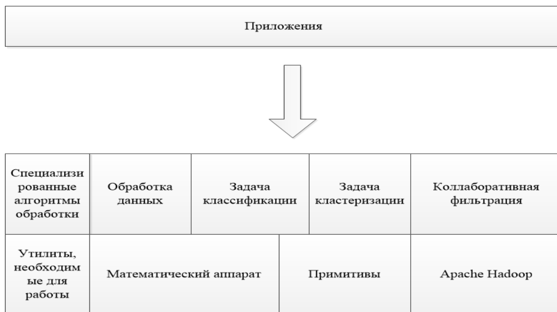
Рис. 1. Типовая архитектура Mahout
