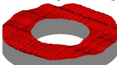
Рис. 3. Модель инженерной поверхности ( D = 4 см, d = 2 см, BU = 15 )
