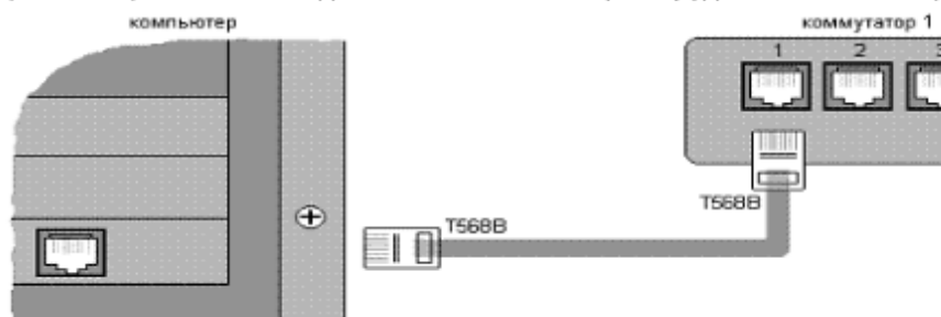
Рис.8. подключения ПК к коммутатору ЛВС кабелем T568B – T568B.
