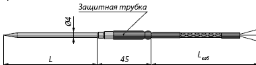
Рис. 1 Термопреобразователь ТС-0295 (общий вид)
