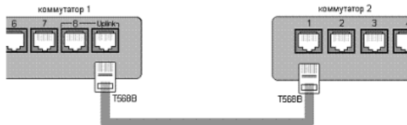
Рис.7. Использование порта "Uplink" для подключения кабеля T568B – T568B.
