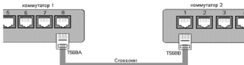
Рис.6. Соединение коммутаторов кабелем с разводкой по стандарту T568A – T568B
