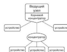
Рис. 2. Топология физической шины USB
