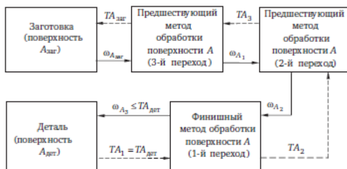
Рис. 1. Схема определения необходимого числа переходов (методов обработки) по обработке поверхности А детали:
