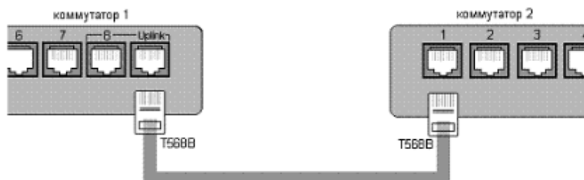
Рис.7. Использование порта "Uplink" для подключения кабеля T568B – T568B.
