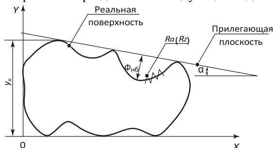
Рис. 1. Геометрическая точность реальной поверхности:
