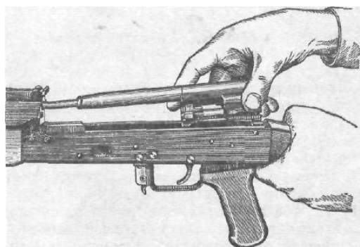
Присоединение затворной рамы с затвором
