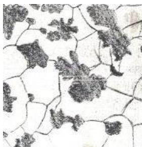
Рис. 10 -Ферритный ковкий чугун - феррит + хлопьевидный графит:
