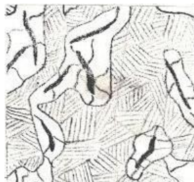
Рис. 2- Ферритно-перлитный чугун – феррит + перлит + пластинчатый графит:
