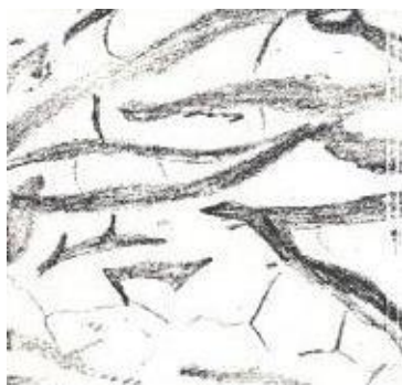
Рис. 1- Ферритный серый чугун – феррит + пластинчатый графит:
