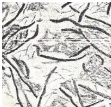
Рис. 2- Ферритно-перлитный чугун – феррит + перлит + пластинчатый графит:
