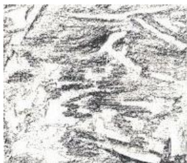
Рис. 5- Половинчатый чугун – перлит + цементит (вторичный) + пластинчатый графит: а – микроструктура, б – схема микроструктуры.
