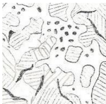
Рис. 6- Половинчатый чугун – ледебурит + пластинчатый графит:
