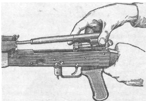
Присоединение затворной рамы с затвором
