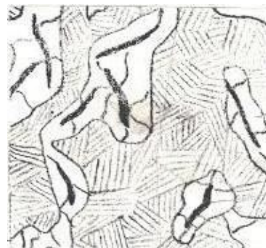
Рис. 2- Ферритно-перлитный чугун – феррит + перлит + пластинчатый графит:
