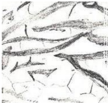
Рис. 1- Ферритный серый чугун – феррит + пластинчатый графит:
