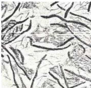
Рис. 2- Ферритно-перлитный чугун – феррит + перлит + пластинчатый графит:
