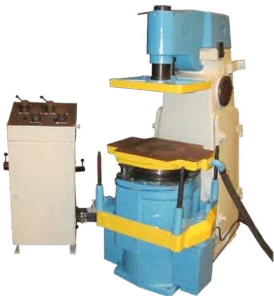
Рисуно 3 - машина формовочная 22111М
