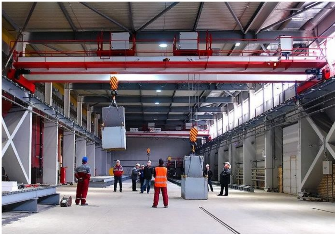
Рисунок 2 – Динамические испытания мостовых кранов
