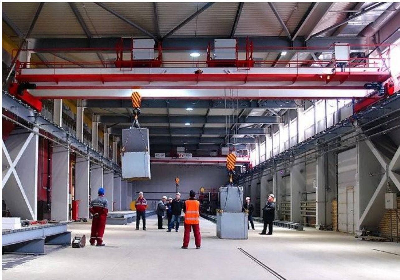
Рисунок 2 – Динамические испытания мостовых кранов
