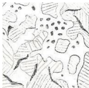
Рис. 6- Половинчатый чугун – ледебурит + пластинчатый графит:
