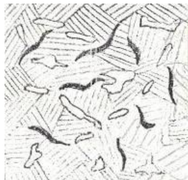
Рис. 5- Половинчатый чугун – перлит + цементит (вторичный) + пластинчатый графит: а – микроструктура, б – схема микроструктуры.
