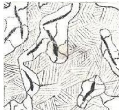
Рис. 2- Ферритно-перлитный чугун – феррит + перлит + пластинчатый графит:
