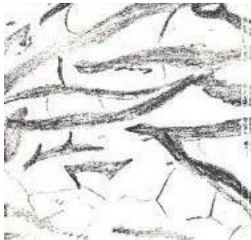
Рис. 1- Ферритный серый чугун – феррит + пластинчатый графит:
