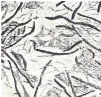
Рис. 2- Ферритно-перлитный чугун – феррит + перлит + пластинчатый графит:
