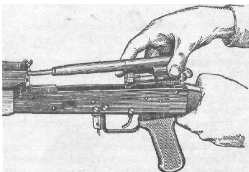
Присоединение затворной рамы с затвором
