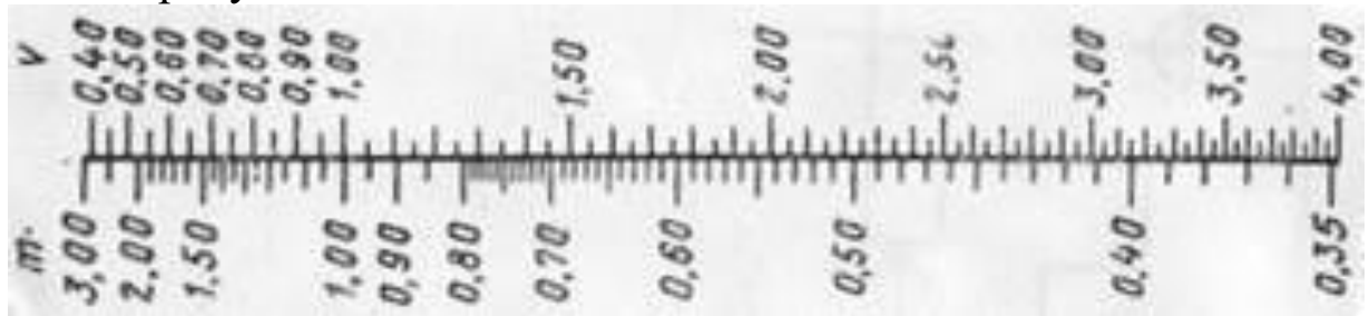
Рис. 5.4. Номограмма для определения параметра закона Вейбулла
