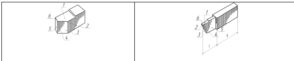
Рис. .1. Элементы рабочей части токарного проходного резца: 1 – передняя поверхность; 2 – главная режущая кромка; 3 – главная задняя поверхность; 4 – вершина резца; 5 – вспомогательная задняя поверхность; 6 – вспомогательная режущая кромка
