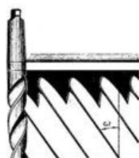
Рис. 9. Измерение угла наклона винтовой канавки w
