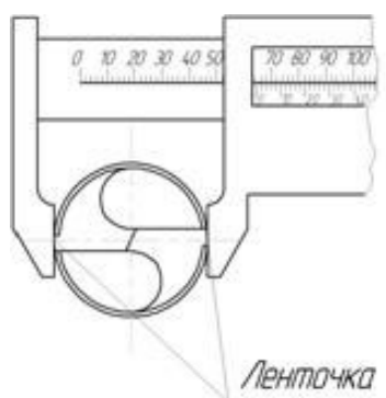
Рис. 4. Измерение диаметра сверла штангенциркулем
