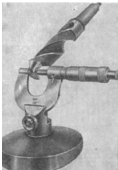
Рис. 5. Измерение толщины сердцевины сверла
