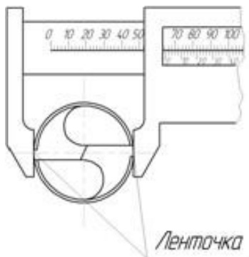
Рис. 4. Измерение диаметра сверла штангенциркулем
