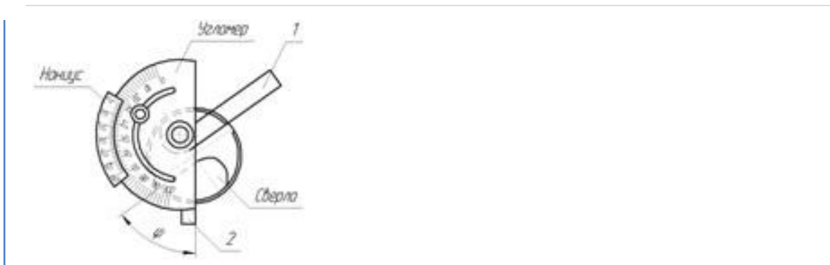
Рис. 8 Измерение угла наклона поперечной кромки универсальным угломером
