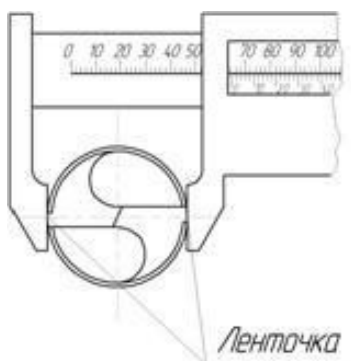
Рис. 4. Измерение диаметра сверла штангенциркулем
