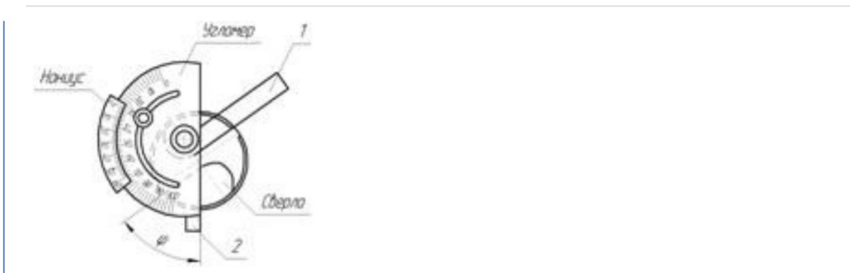
Рис. 8 Измерение угла наклона поперечной кромки универсальным угломером
