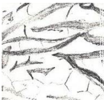
Рис. 1- Ферритный серый чугун – феррит + пластинчатый графит:
