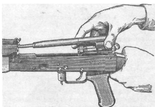
Присоединение затворной рамы с затвором
