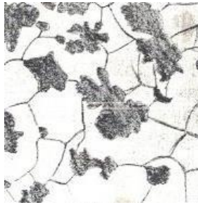
Рис. 10 -Ферритный ковкий чугун - феррит + хлопьевидный графит:
