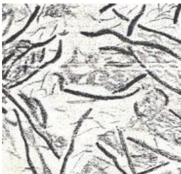
Рис. 2- Ферритно-перлитный чугун – феррит + перлит + пластинчатый графит:
