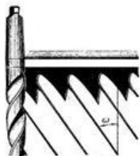
Рис. 9. Измерение угла наклона винтовой канавки \alpha
