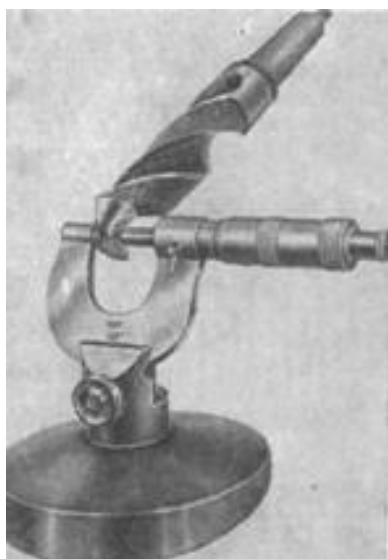
Рис. 5. Измерение толщины сердцевины сверла
