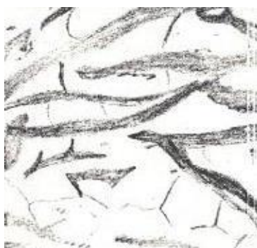
Рис. 1- Ферритный серый чугун – феррит + пластинчатый графит:
