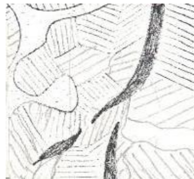
Рис.4- Серый чугун с фосфидной эвтектикой - перлит + пластинчатый графит + эвтектика, располагающаяся полностью или частично по границам зерен.
