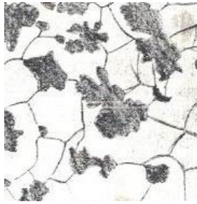
Рис. 10 -Ферритный ковкий чугун - феррит + хлопьевидный графит:
