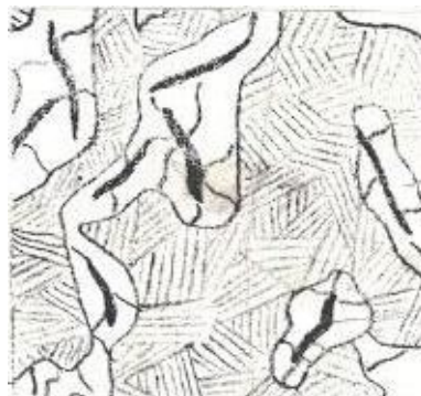
Рис. 2- Ферритно-перлитный чугун – феррит + перлит + пластинчатый графит:
