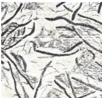
Рис. 2- Ферритно-перлитный чугун – феррит + перлит + пластинчатый графит:
