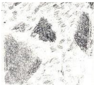
Рис. 12- Перлитный ковкий чугун - перлит и хлопьевидный графит:
