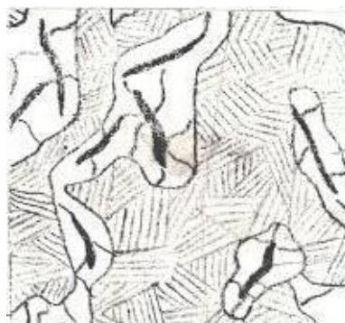
Рис. 2- Ферритно-перлитный чугун – феррит + перлит + пластинчатый графит:
