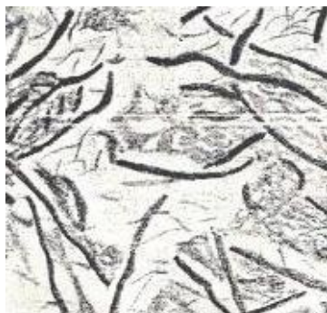
Рис. 2- Ферритно-перлитный чугун – феррит + перлит + пластинчатый графит:
