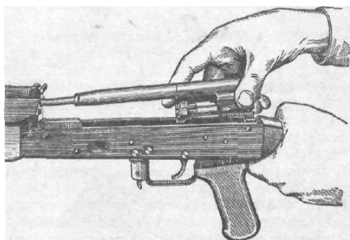
Присоединение затворной рамы с затвором
