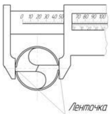
Рис. 4. Измерение диаметра сверла штангенциркулем
