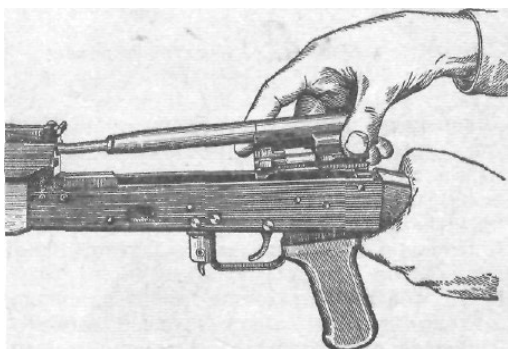
Присоединение затворной рамы с затвором
